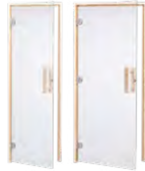
Saunatür DS40 3-seitiger Rahmen, Klarglas 8 mm ESG, Bänder links oder rechts anschlagbar Glas: 590 oder 680 x 1915 mm Rahmen Fichte: 650 oder 740 x 1960 x 40 mm Art.-Nr. DS40-3CS-590 (590 mm Breite) Art.-Nr. DS40-3CS-680 (680 mm Breite)
