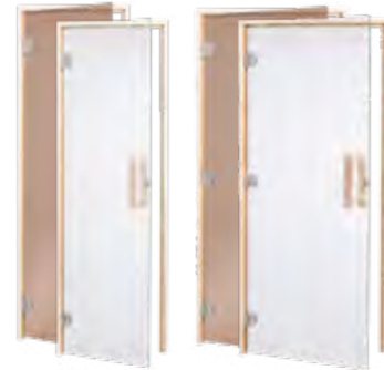
Saunatür DS80 3-seitiger Rahmen, Klarglas oder Bronze 8 mm ESG, Bänder links oder rechts anschlagbar Glas: 590 oder 680 x 1915 mm Rahmen Fichte: 650 oder 740 x 1960 x 80 mm Art.-Nr. DS80-3CS-590 (Klarglas, 590 mm Breite) Art.-Nr. DS80-3BS-590 (Bronze, 590 mm Breite) Art.-Nr. DS80-3CS-680 (Klarglas, 680 mm Breite) Art.-Nr. DS80-3BS-680 (Bronze, 680 mm Breite) Art.-Nr. DS80-3CS-824 (Klarglas, 824 mm Breite)
